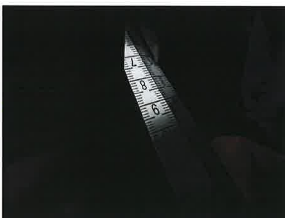
图 16：轿门门扇与立柱之间的间隙大于 6mm
