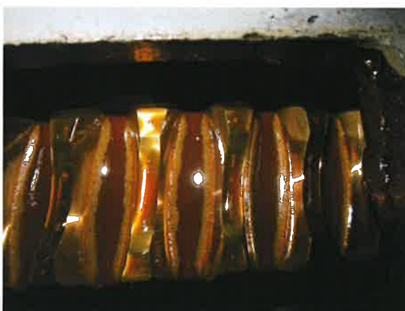
图 18：减速箱涡轮状况良好
