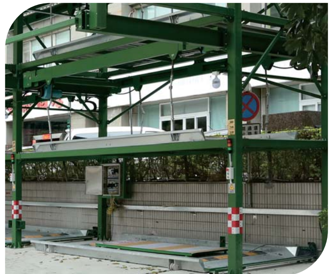
快易停载车板直接放在横梁上
