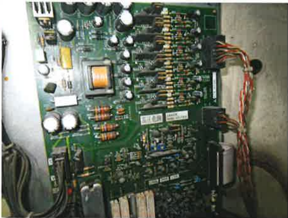
图 4：调速装置的驱动电子板老化
