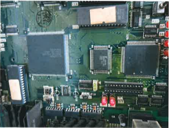
图 5：电梯主控电子板老化
