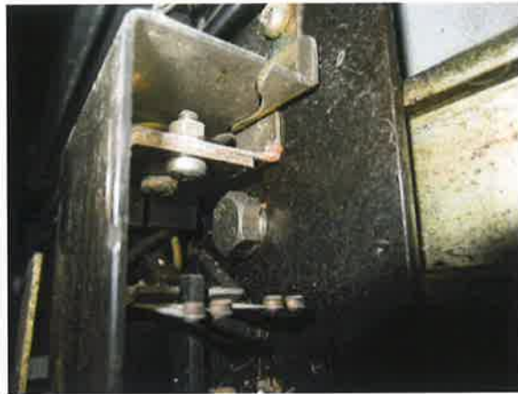
图 20：层门门锁电气开关触点氧化
