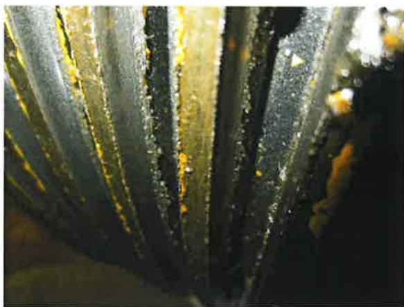
图 13: 曳引轮绳槽有不规则磨损
