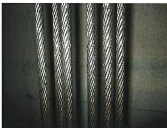
图 14: 曳引钢丝绳有一定程度磨损和金属疲劳
