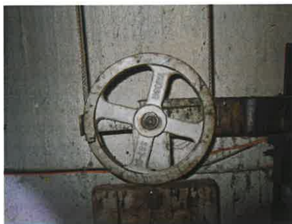
图 21：张紧轮未设置防异物进入的防护罩
