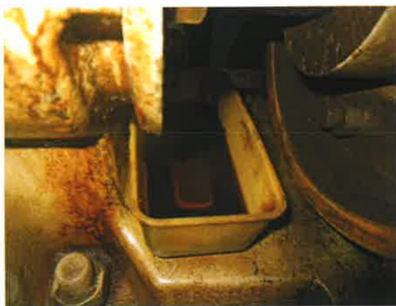
图 9：减速箱密封不良，存在渗漏油现象
