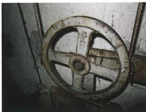
图 21: 张紧轮未设置防异物进入的防护罩
