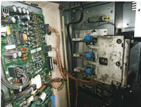
图 4：调速装置的驱动电子板老化
