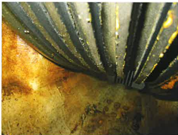
图 13: 曳引轮绳槽有不规则磨损
