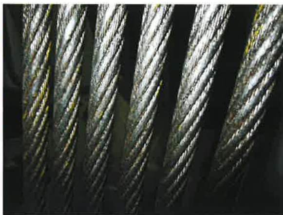
图 14: 曳引钢丝绳有一定程度磨损和金属疲劳
