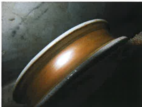
图 15: 轿门门挂轮导向胶老化
