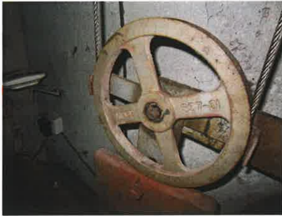
图 21: 张紧轮未设置防异物进入的防护罩
