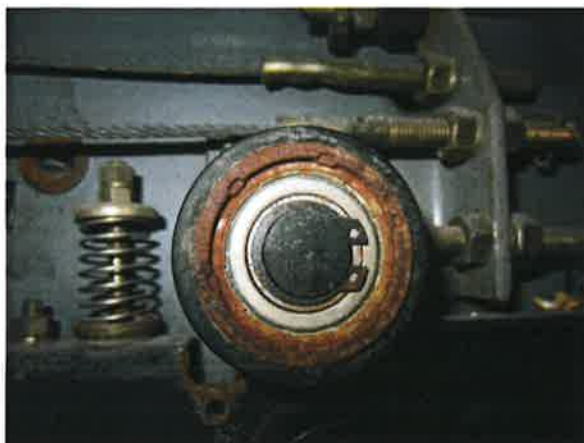
图 17: 层门锁紧装置门滚轮锈蚀
