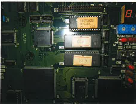
图 5: 电梯主控电子板老化
