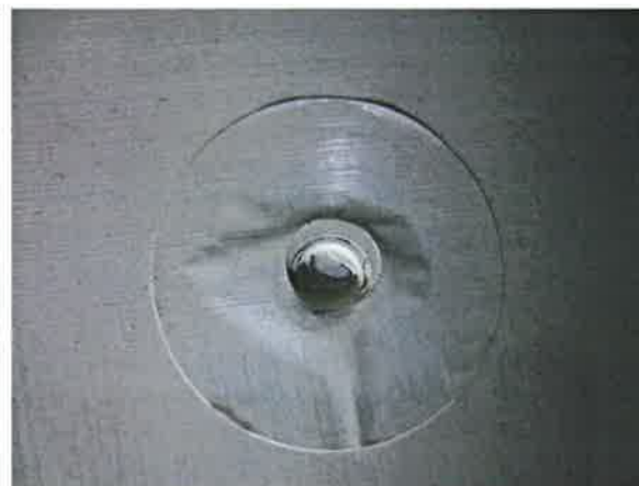
图 18: 层门紧急开锁装置失效
