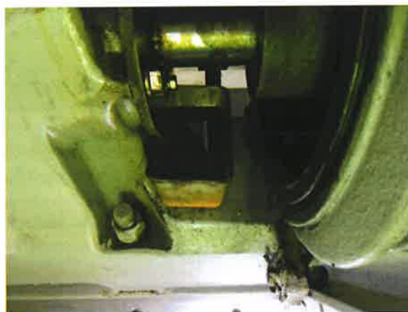
图 9：减速箱密封不良，存在渗漏油现象
