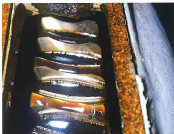
图 11：传动副啮合面未发现明显的啮合缺陷
