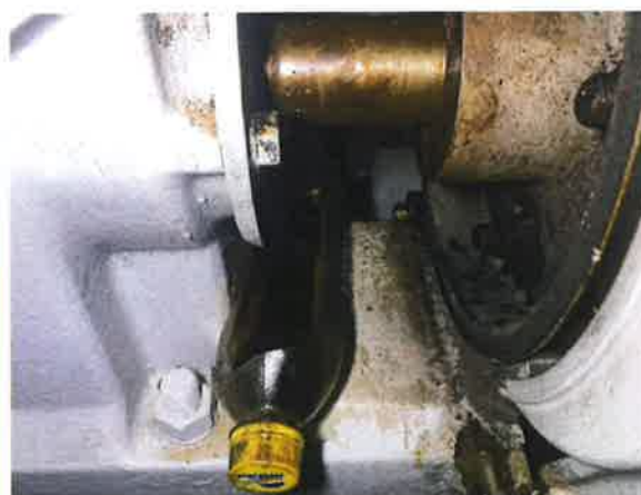
图 12：减速箱密封不良，存在渗漏油现象
