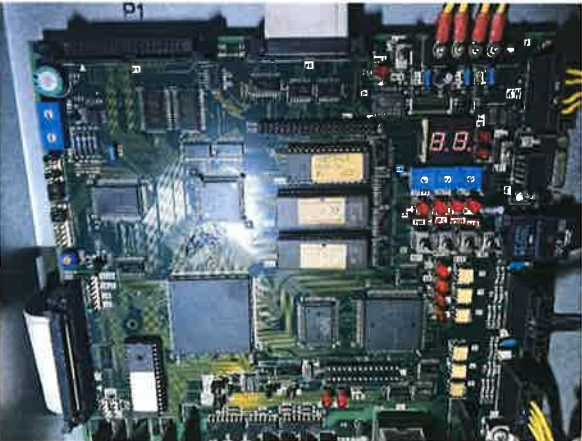
图 5：电梯主控电子板老化
