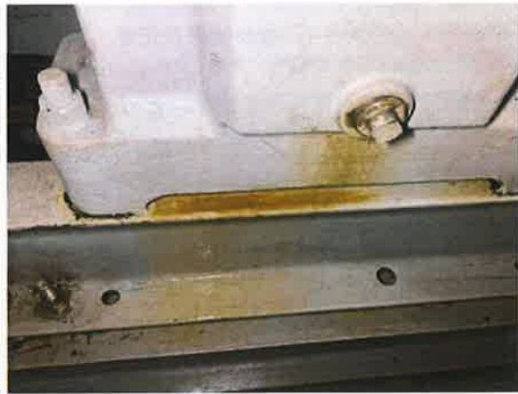
图 10：减速箱密封不良，存在渗漏油现象
