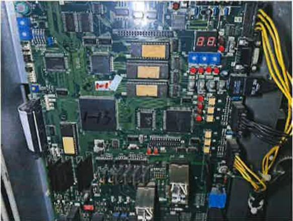
图 4：电梯主控电子板老化
