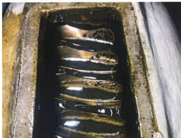
图 11：传动副啮合面存在明显的啮合磨损缺陷
