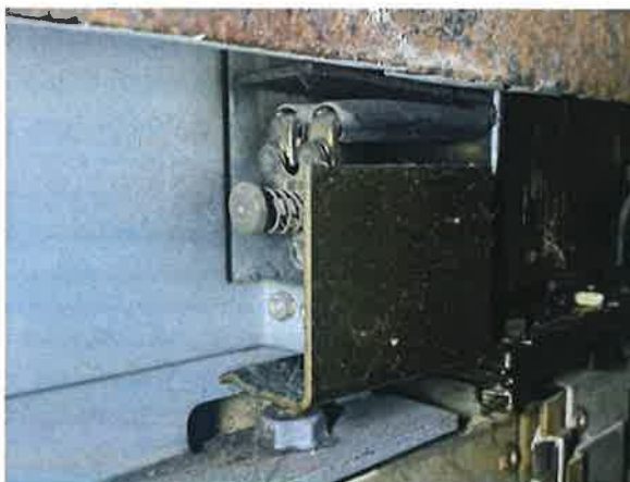
图 15: 层门门锁电气开关触点氧化
