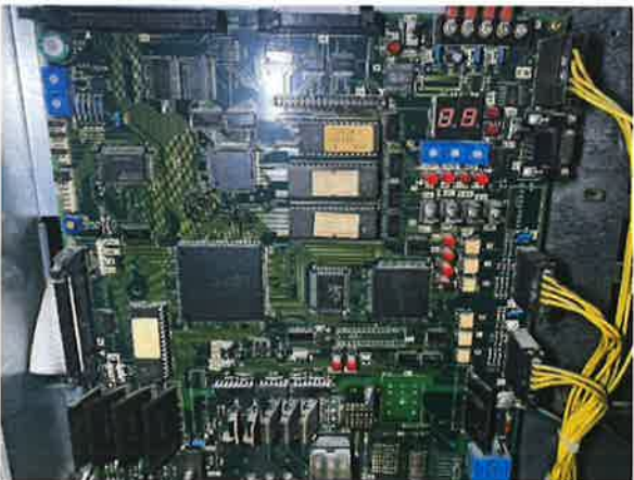
图 6：电梯主控电子板老化
