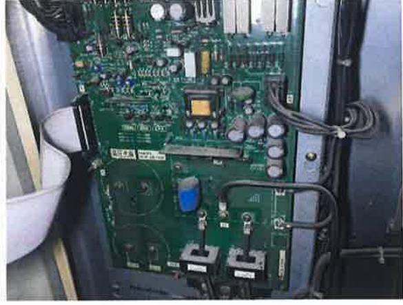
图 8：调速装置的驱动电子板老化
