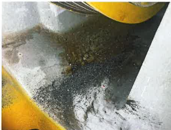
图 13: 减速箱密封不良, 存在渗漏油现象
