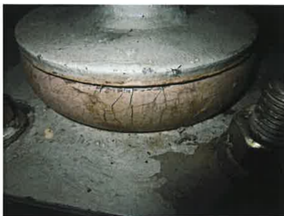
图 14：主机减震胶老化变形
