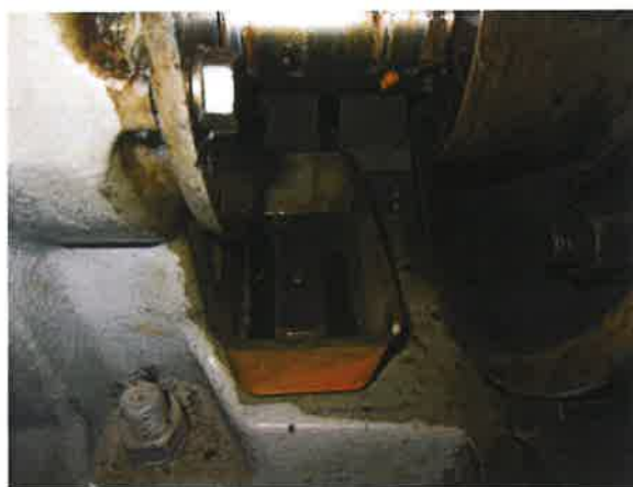
图 9: 减速箱密封不良, 存在渗漏油现象
