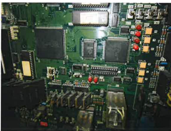
图 5: 电梯主控电子板老化
