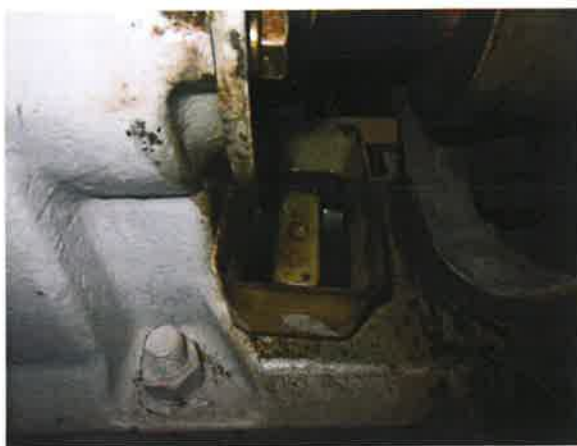
图 9：减速箱密封不良，存在渗漏油现象
