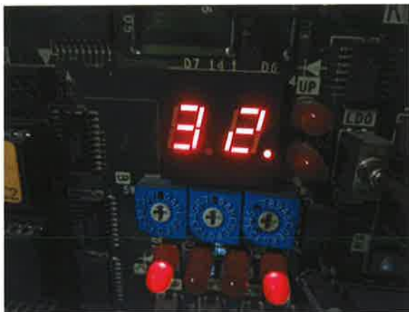
图 19: 超载检测装置失效
