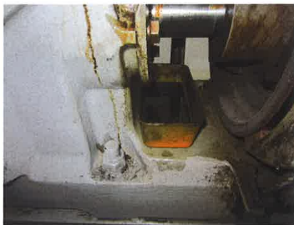
图 14: 减速箱存在渗漏油现象
