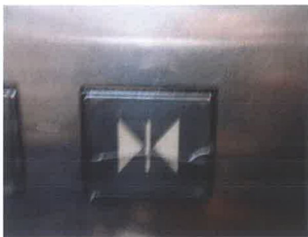
图 8：轿厢部分召唤按钮破损且动作不良
