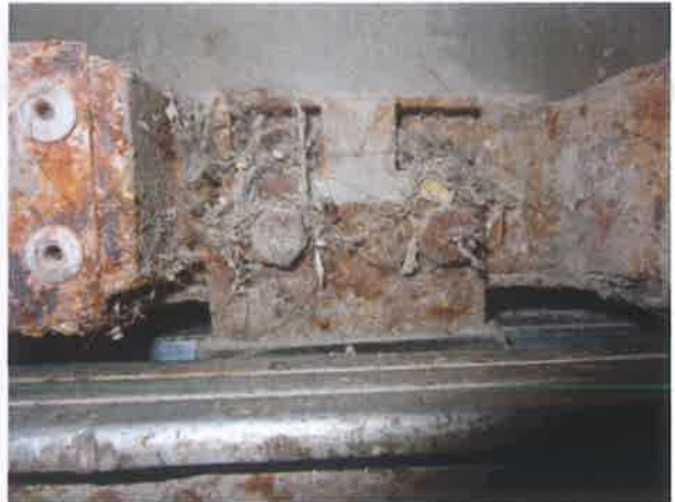
图 22：层门门滑块锈蚀磨损
