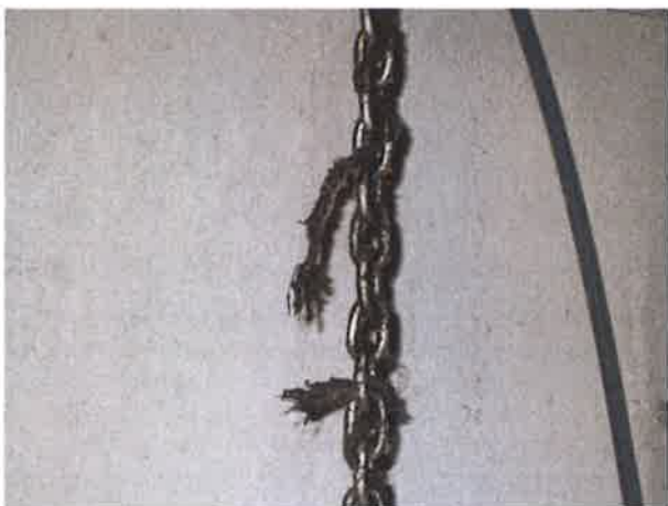
图 27: 补偿链消音绳断裂
