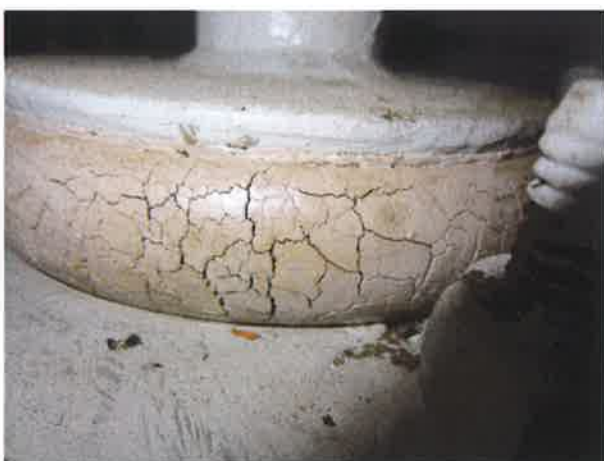
图 15: 主机减震胶老化龟裂
