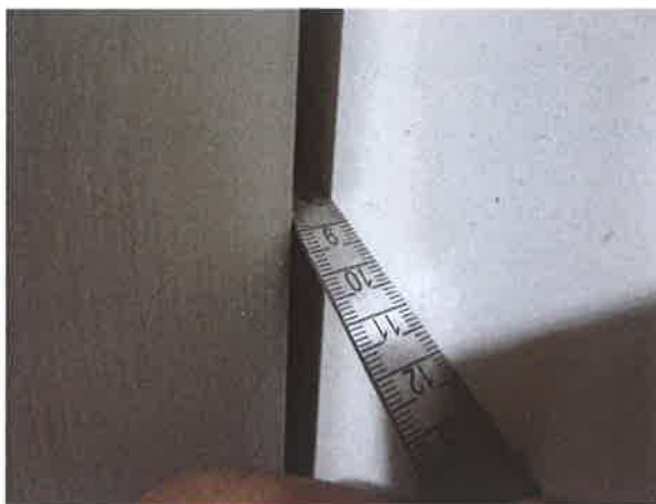
图 26: 门扇与立柱间隙大于 6mm
