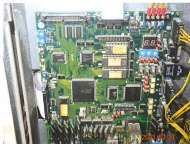
图 6: 控制主板电子元器件存在老化
