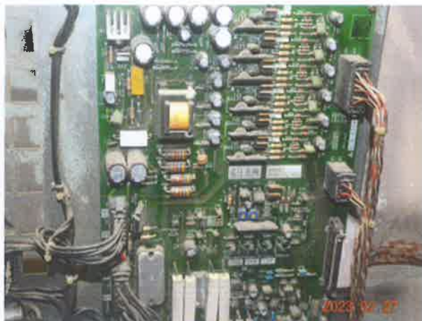
图 7: 驱动装置变频器电子器件存在老化
