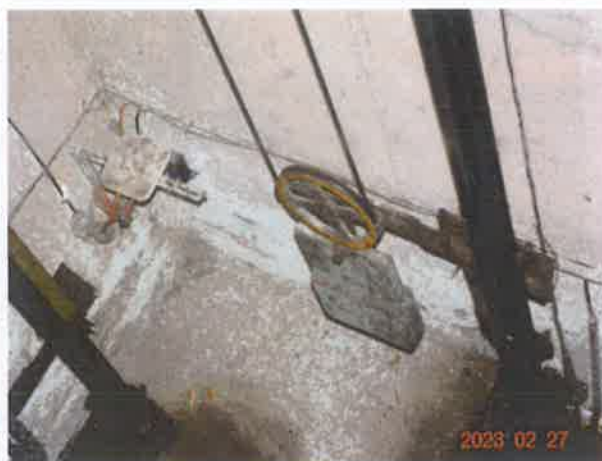
图 22：张紧轮旋转部件未设置防异物防护罩
