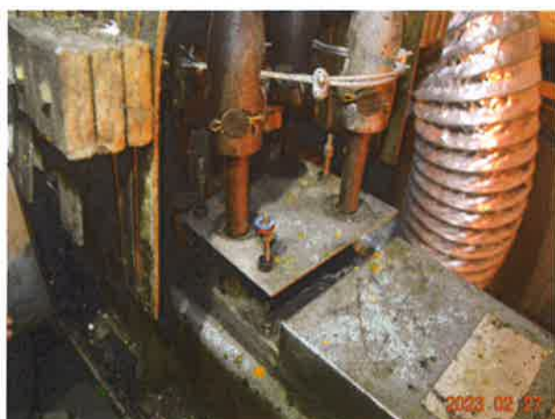
图 17：超载检测装置失效
