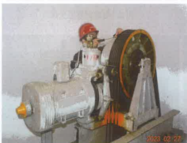
图 9: 曳引轮未设置防止异物进入的防护装置
