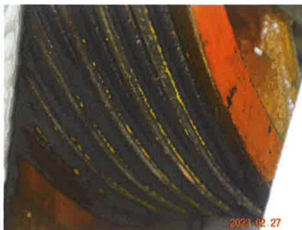
图 14：曳引轮绳槽存在不规则的磨损
