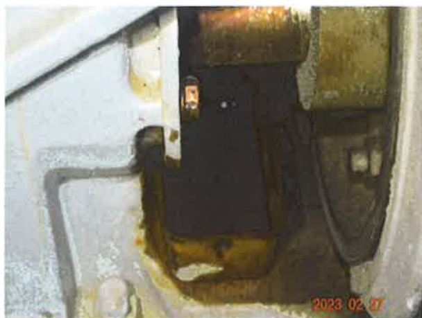
图 13：减速箱存在渗漏油现象
