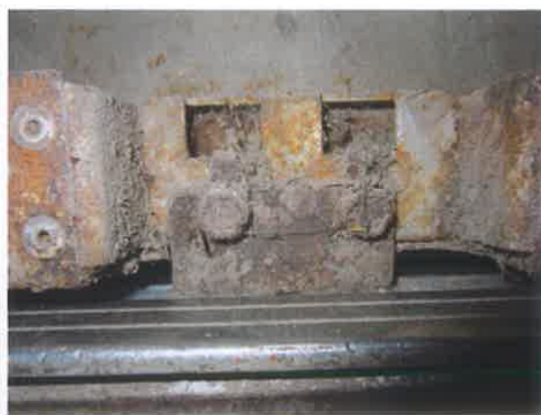
图 22：层门门滑块锈蚀磨损
