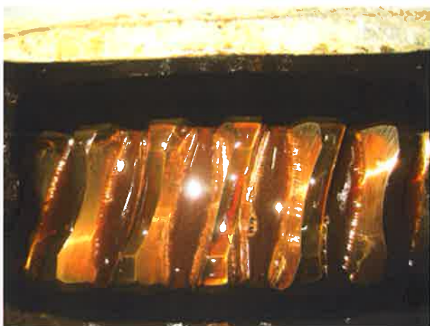
图 13：减速箱涡轮蜗杆状况良好
