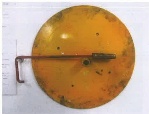
图 12：可拆卸盘车手轮无相应电气开关
