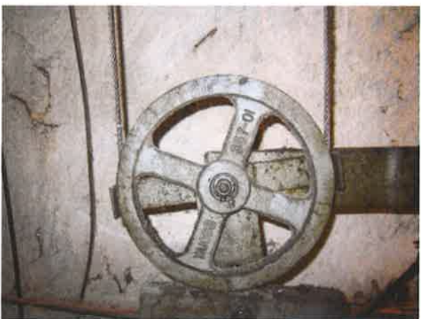
图 29: 张紧轮无防止异物进入的防护装置
