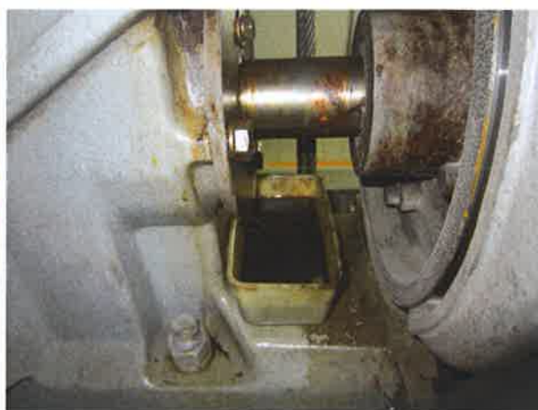
图 14：减速箱存在渗漏油现象
