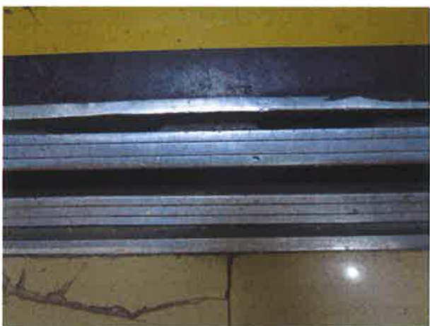
图 27: 轿门地坎磨损变形
