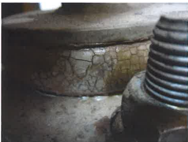
图 15：主机减震胶老化龟裂
